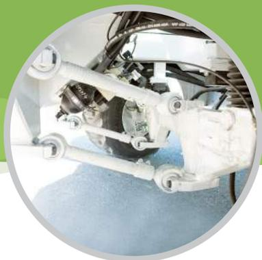
Suspension hydraulique optionnel
