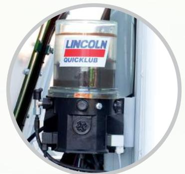
Graissage centralisé avec pompe
