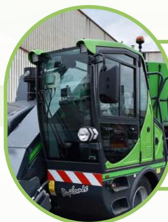
La grande surface vitrée donne une visibilité maximale, partie supérieure de la cabine comprise, ce qui garantit un contrôle parfait durant l'opération de fraisage.
