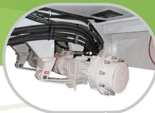
La máquina viene de serie con suspensión delantera por ballestas que asegura el máximo confort del operador en terrenos accidentados; opcionalmente pueden ponerse también ballestas sobre el eje trasero.
