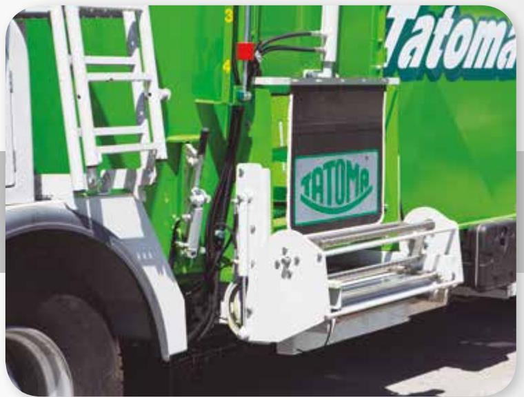
El sentido de rotación de la fresa es reversible gracias a dos pedales de accionamiento eléctrico que nos permite un control de la carga más preciso ya que podemos detener la carga y revertir el producto cuando se alcanza la cantidad requerida.
