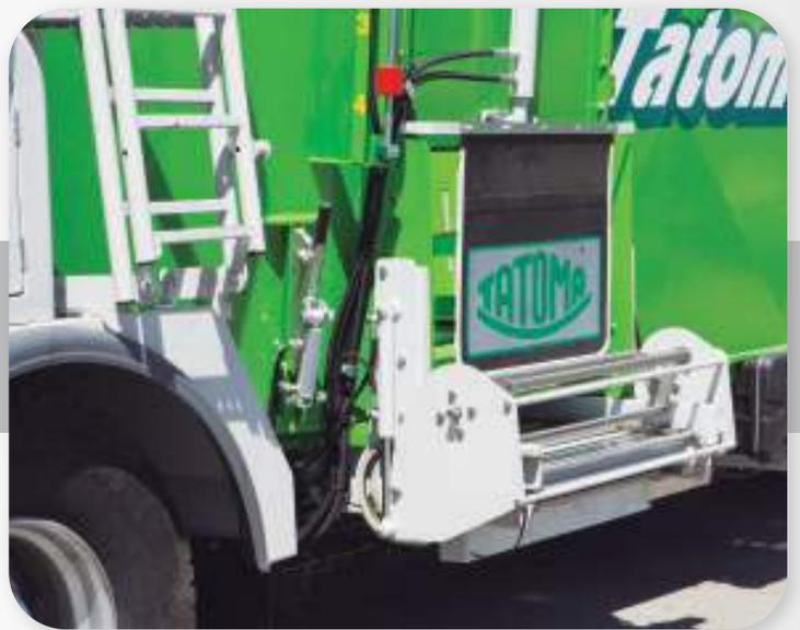
Le sens de rotation de la fraise est réversible grâce à deux pédales à commandes électriques qui permettent de contrôler le chargement de manière plus précise car l'on peut arrêter le chargement et faire redescendre le produit lorsque la quantité requise est atteinte.
