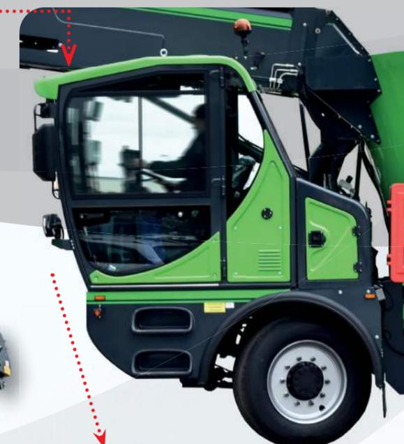
La géométrie de la cabine avec inclinaison négative, évite que la poussière s'accumule sur la partie supérieure et assure une parfaite visibilité durant tout le processus de chargement. Le toit partiellement vitré nous permet de contrôler la coupe de la fraise lorsque celle-ci est en position haute.
