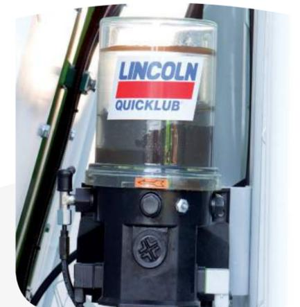
Graissage centralisé avec pompe
