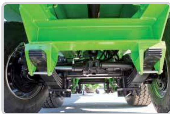
Tandem direccional de serie en MV 30 y 35 (opcional forzado)
