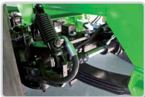
Tandem direccional de serie en MV 30 y 35 (opcional forzado)
