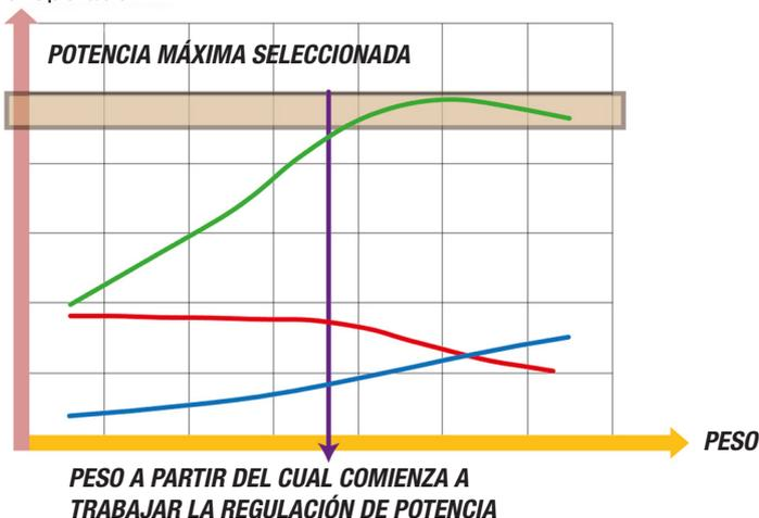
CONFORME SE CARGA EL MEZCLADOR LA PRESIÓN AUMENTA YA LA VELOCIDAD SE MANTIENE AL MÁXIMO HASTA ALCANZAR LA POTENCIA MÁXIMA SELECCIONADA, A PARTIR DE ESE MOMENTO EL AUMENTO DE CARGA LLEVA APAREJADO UNA DISMINUCIÓN DE LA VELOCIDAD.
