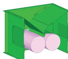
Rodillos de trituración ajustados hidráulicamente
