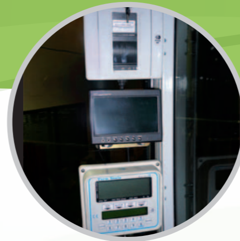
Sistema de peso programable. Opcional impresora y cámara de video trasera e interior cuba.
