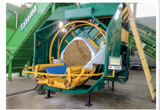
\* Prensa plastificadora de mezcla, TRASA, para 15 t/h.
